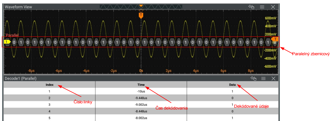
Obrázok 18.3 Tabuľka udalostí paralelného dekódovania
