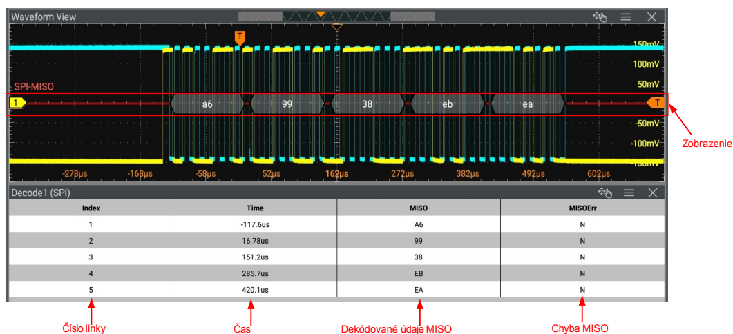
Obrázok 18.12 Tabuľka udalostí dekodovania SPI
